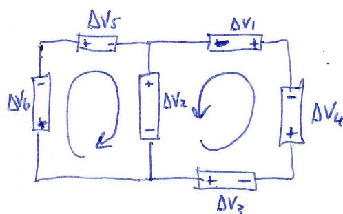
$$\begin{cases} \Delta V_1 + \Delta V_2 + \Delta V_3 + \Delta V_4 = 0 \\ \Delta V_6 + \Delta V_5 + \Delta V_2 = 0 \\ \Delta V_6 + \Delta V_5 - \Delta V_1 - \Delta V_4 - \Delta V_3 = 0 \end{cases}$$
